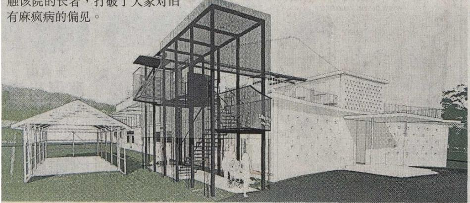
▲故事馆将以铁作为主要材质，减低建筑的自重，以免破坏古迹原有的建设。
